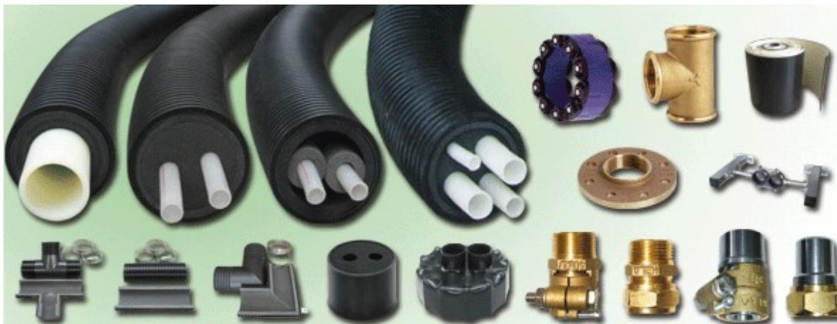
Flexible Nah- und Fernwärmeleitungen für erhöhte Wirtschaftlichkeit nach EN15632, mit PE-Xa Rohr nach DIN 16892/16893, mit EVOH Sauerstoffdiffusionssperrschicht SDR11. Spezieller Aufbau aus geschlossenzelligem PE-Schaum mit Luftkammernsystem für verbesserte Dämmeigenschaften.
