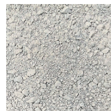
ZERKLEINERTES MATERIAL: Brechgut Mischung Fraktion 0-16 mm
