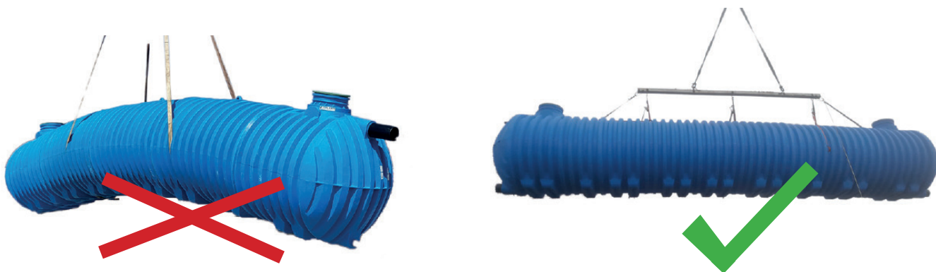
Abb. 2: Anheben des Behälters mit Hilfe einer Konsole und Lastgurten
